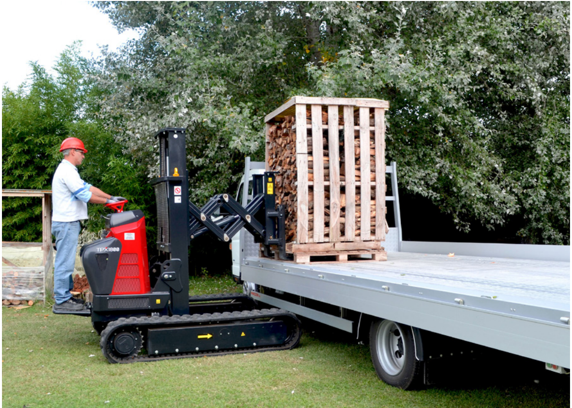
► Transport of firewood and pellets. Transport von Brennholz und Pellet.
